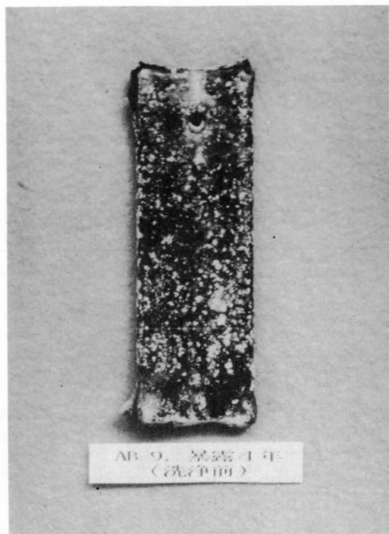
写真-1 腐食状況(SS-41+タールエボ ® , 気相)
