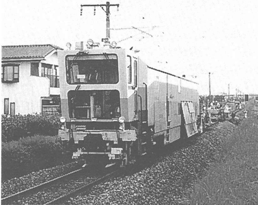
図-10 マルチプルタイタンバ (道床砕石突き固め作業車)
