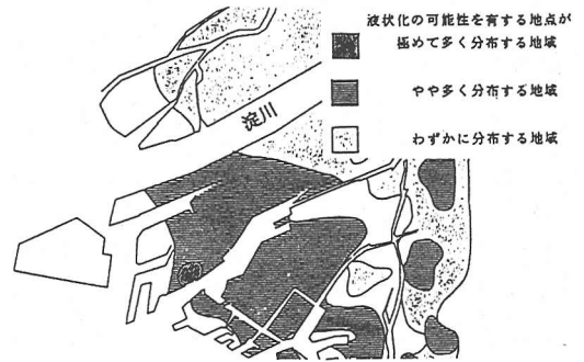
図-6 大阪地盤の液状化総合評価図 11)
