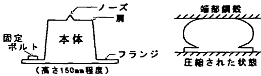
図-2 ジーナ型ゴムガスケット
