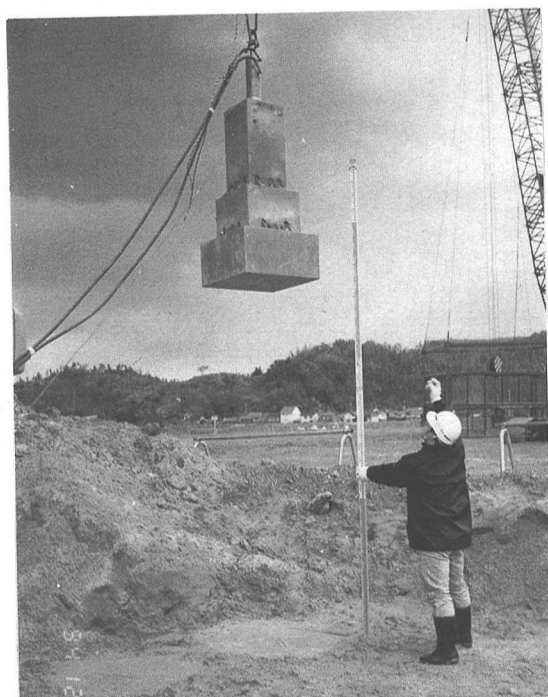
写真-2 大型重錘(C6)の実験状況
