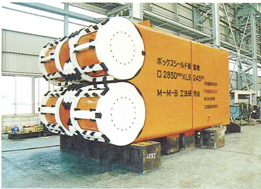
写真-1 ボックスシールド機
