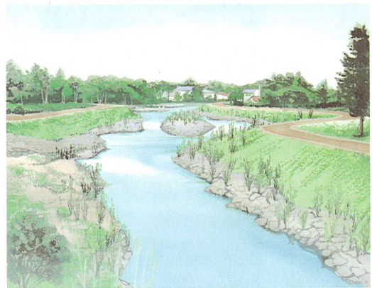
(b) フラクタルを用いた設計支援による護岸工のイメージパース図
