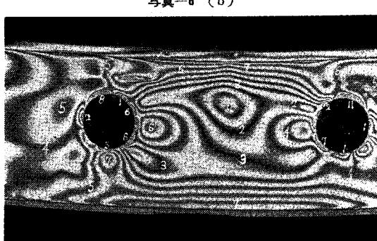
図-3.9 一様なせん断応力（相等しい引張力および圧縮力の2主応力）を受けた場合の応力分布
