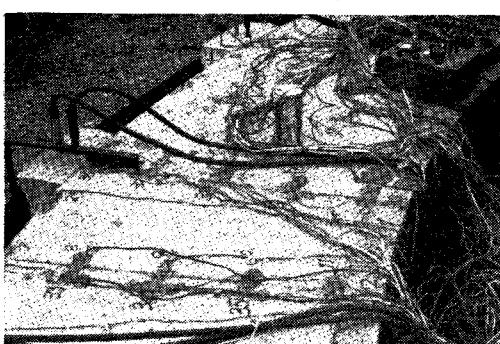
a) カールソン型ひずみ計によるコンクリートひずみ測定 カールソン型ひずみ計（土木測器センター製、L-10 B型）19 個を図-6 に示す位置に配置した。19 個のひずみ計のうち 2 個は無応力計である。プレストレッシング時の半径方向および切線方向のコンクリートひずみを測定した。
