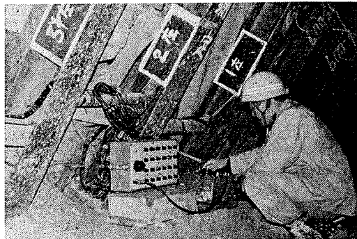
写真—11 鋼支保工とコンクリート覆工に設置したカーボンひずみ計のスイッチ ボックスよりひずみ度を測定している所 (コンクリート覆工打設後)
