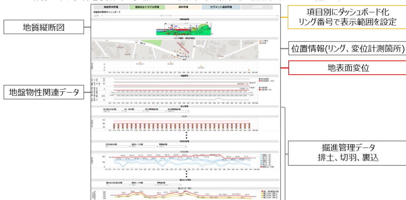
図-2 地盤変状管理ダッシュボード
