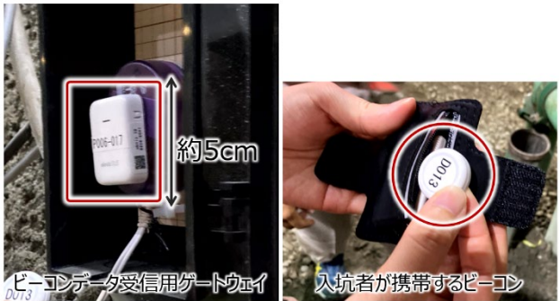
図-3 坑内の人の所在管理に必要な機器
