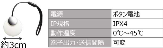
図-1 BLE ビーコンの概要
