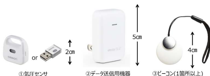
図—6 高さ測位に必要な設置機器
