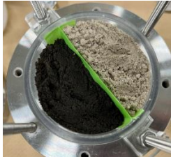
図 3 混合しない状態のカラム内の様子 (BB+FC)
