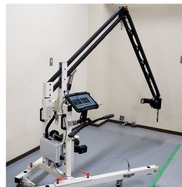
図2 壁高欄測定ロボット
