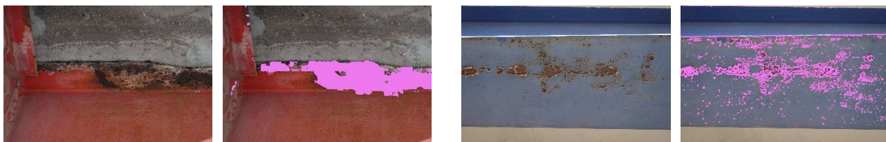
(a)腐食（左：入力画像、右：検出結果）
