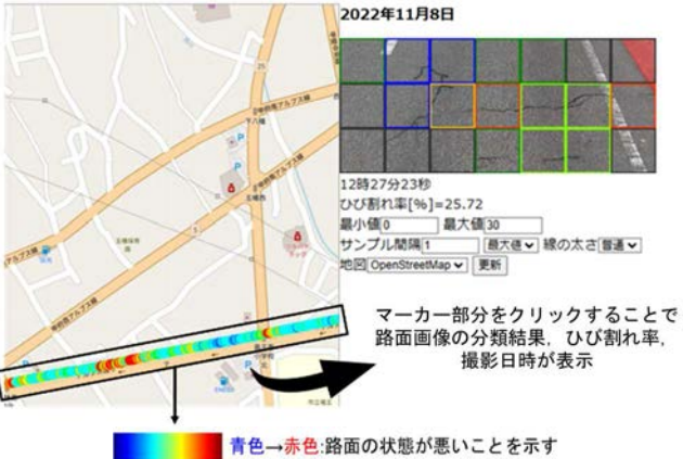
図-6 連続する路面画像の「ひび割れ率」の地図上への表示例
