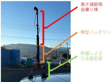
図-1 路面の画像計測装置の車載の状況
