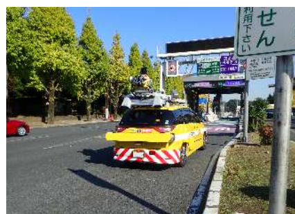
図-1 測定車両による舗装点検
