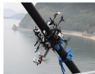
図2 斜張橋ケーブル点検ロボット
