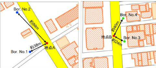
図-6 推定位置と設計に用いたボーリング位置との位置関係
