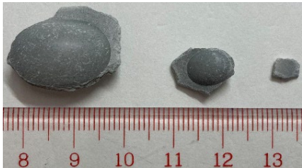
図-1 ベントナイトペレット (左から大ペレット, 中ペレット, 小ペレット)
