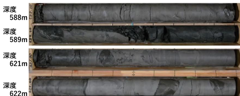
写真-2 細粒凝灰岩および凝灰質砂岩の挟在割合が高い区間におけるコア写真
