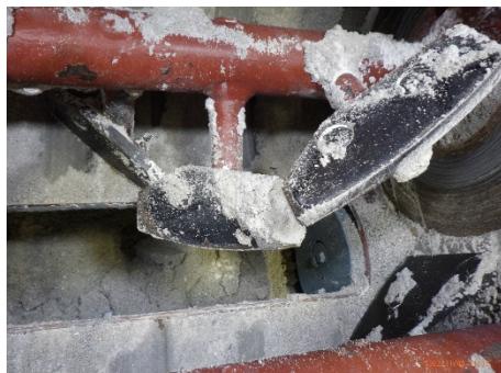
図-5 攪拌翼付着状況（コーティング無し）
