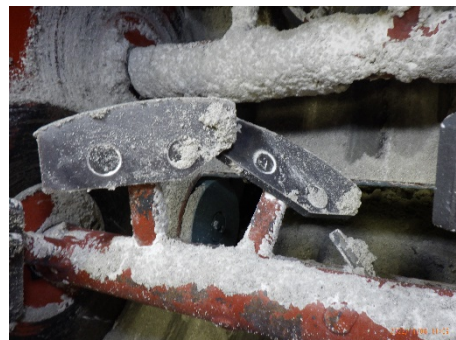
図-6 攪拌翼付着状況（2層式有機系溶剤）
