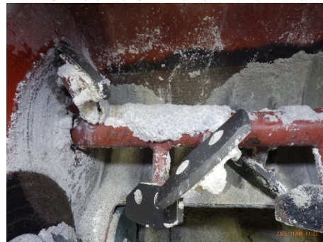
図-8 攪拌翼付着状況（フッ素樹脂+溶射）
