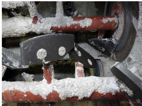
図-7 攪拌翼付着状況（フッ素樹脂）
