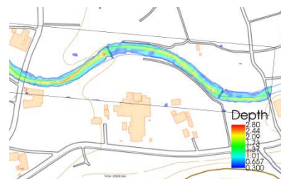
図-6 最大浸水深の解析結果(case-2)
