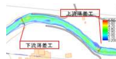
図-8 最大流速の解析結果(case-2)
