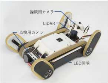
図-1 狭隘部点検ロボット
