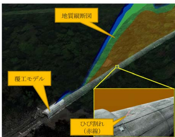
図-4 BIM/CIM モデル構築
