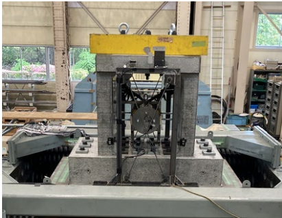
図 4 試験体取り付け状況
