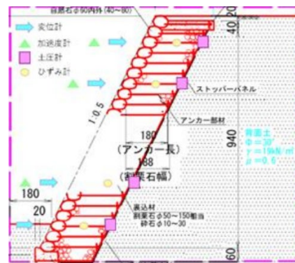
図-2 計測機器の配置
