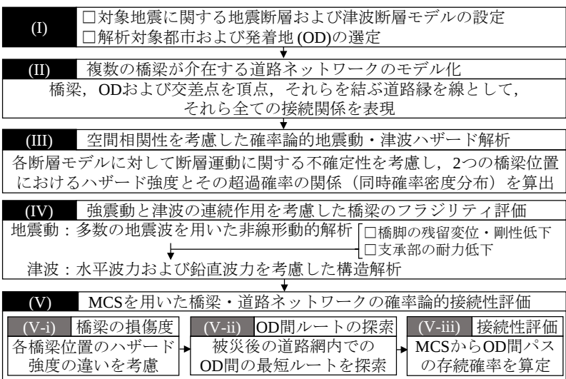
図-1 橋梁・道路ネットワークの確率論的接続性の評価手順
