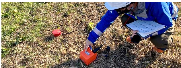
写真1. 河川堤防における常時微動測定時の様子
