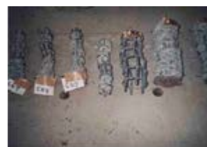
図-6 中心軸をせん断補強した供試体の圧縮試験結果
