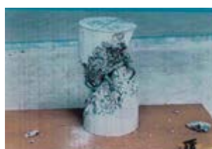
図-6 中心軸をせん断補強した供試体の圧縮試験結果
