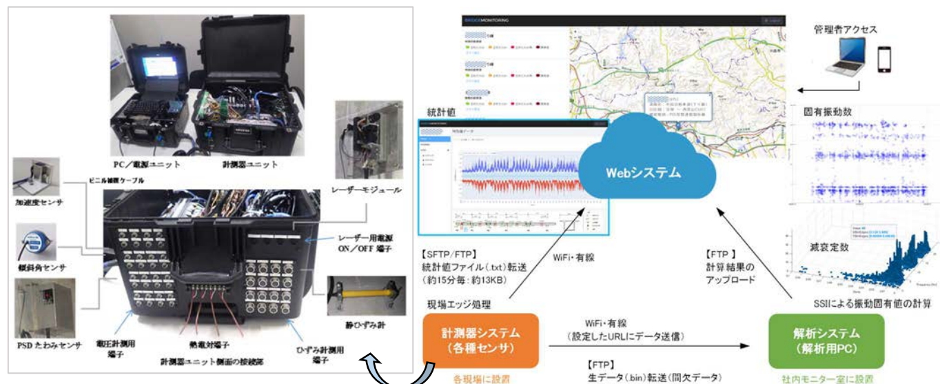
図-2 橋梁モニタリング計測システムの概要
