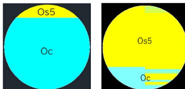
図-5 1240Rでの想定断面図(左)と計測結果(右)
