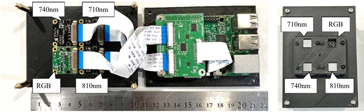
図-1 Raspberry Pi3 にカメラモジュール、赤外線バンドパスフィルタを付けたマルチスペクトルカメラ
