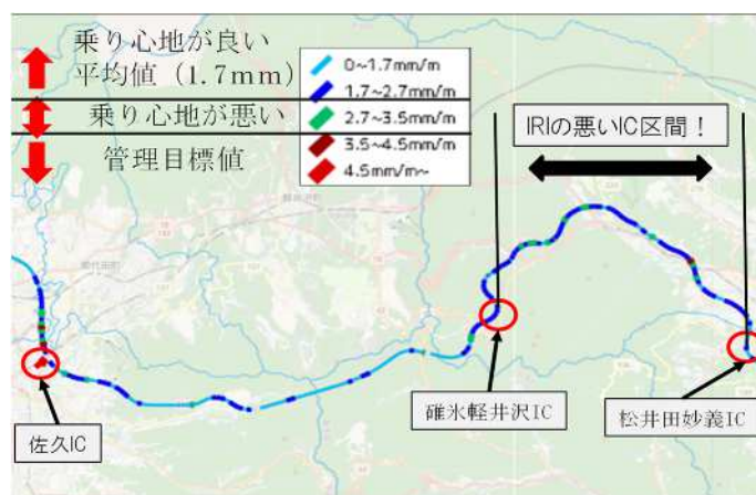
図-2 上信越自動車道上り線 IRI 測定結果 (抜粋)
