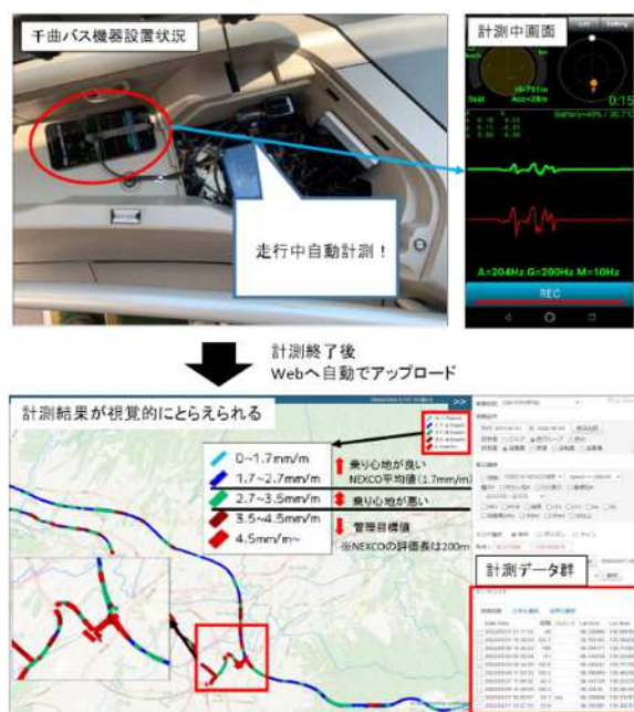
図-1 計測機器設置状況及び計測結果画面
