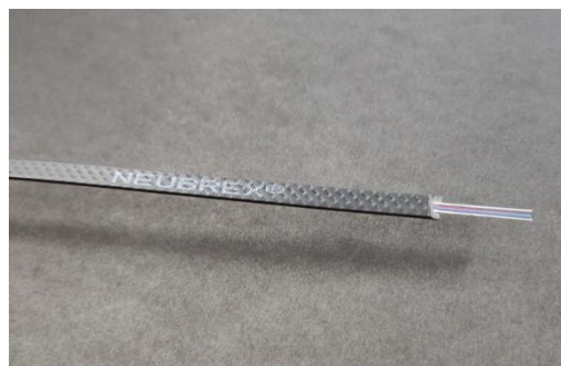
図-2 ひずみ計測専用光ファイバセンサケーブルの例
