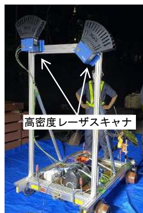
図-4 高密度レーザスキャナの設置状況および計測状況
