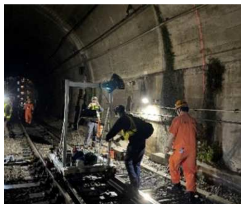
図-4 高密度レーザスキャナの設置状況および計測状況
