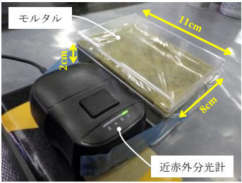
図1 モルタルの近赤外線スペクトルの計測状況
