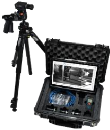
図-1 非接触ノンターゲット画像計測システム
