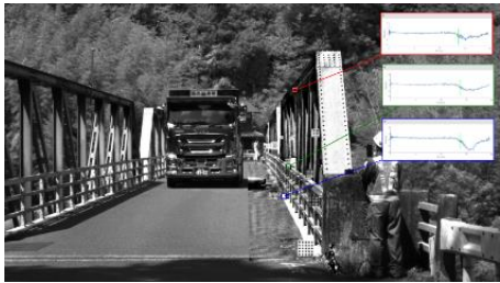
図-2 多点計測状況(動的載荷試験実施時)
