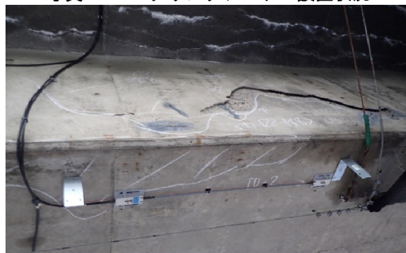
写真-2 光学ストランドセンサ設置 PC 箱桁下面
