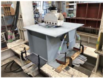
図 4 定点疲労載荷状況
