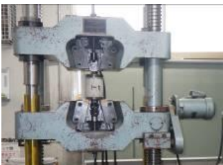
写真-1 付着力試験状況
