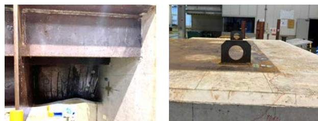
1)主桁下フランジ座屈 2)橋台天端面(浮上りなし) 写真-1 最大荷重作用後の剛結部の状態
