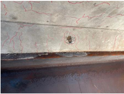
写真-2 加熱後のコンクリート部材
