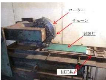
図-2 ラベリング試験の実施状況
