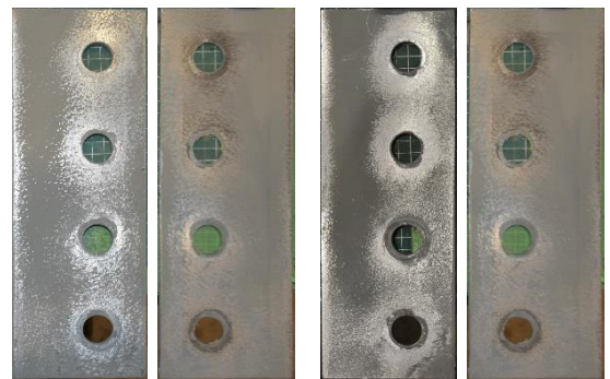
(a) S 側 (すべり破壊) (b) N 側 (すべり破壊) 図-3 試験後のすべり面の状況 (080B 試験体)
