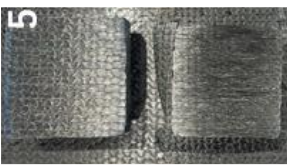
(a) 繊維層間 (V-N) (b) CFRP-接着樹脂間 (E-H)
