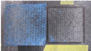
(a) 繊維層間 (V-N) (b) CFRP-接着樹脂間 (E-H)
