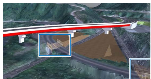
図-5 点群測量結果の周辺構造物としての活用
