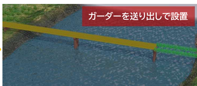
図-4: Step2: ガーダーを送り出し工法で設置
