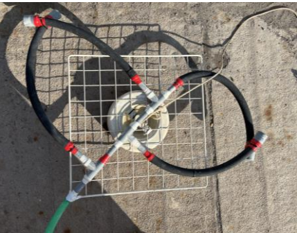
写真-2 散気管の構造
