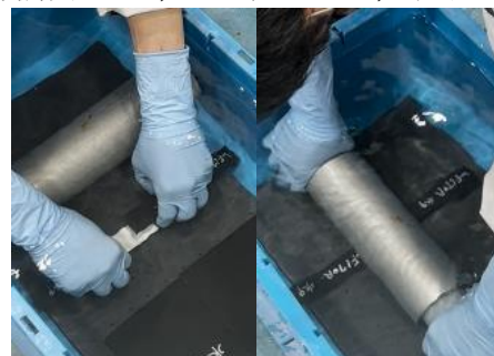
写真-1 海水中の遮水シート接合状況
